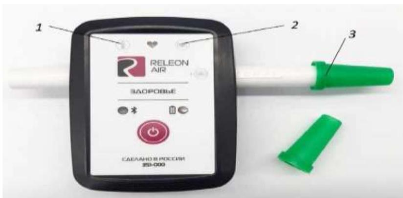
Рис. 3. Мультидатчик по физиологии. Обозначение разъемов и технологических отверстий: 1 — температура тела, 2 — пульс, 3 — частота дыхания (надет съёмный мундштук)
