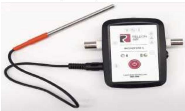
Рис. 6. Датчик температуры растворов
