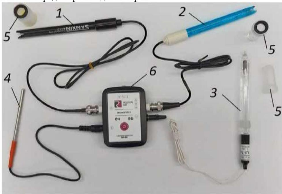
Рис. 9. Снаряженный мультидатчик по экологии. Обозначения: 1 — щуп датчика электропроводности, 2 — щуп датчика рН, 3 — электрод сравнения, 4 — щуп датчика температуры, 5 — защитные колпачки (сняты)
