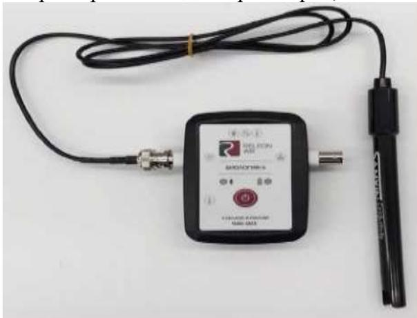
Рис. 5. Датчики электропроводности
