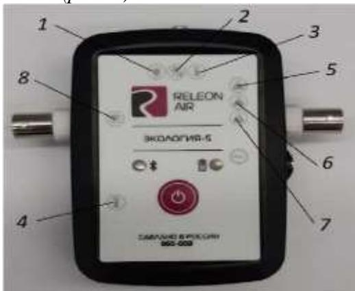
Рис. 2. Мультидатчик по экологии. Обозначение разъемов и технологических отверстий: 1 — освещённость, 2 — относительная влажность воздуха, 3 — температура окружающей среды, 4 — температура растворов, 5 — нитрат-ионы, 6 — хлорид-ионы, 7 — pH, 8 — электропроводность
